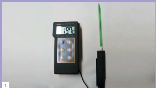
Abb. 1: LCD Handthermometer mit modifiziertem Temperaturfühler
